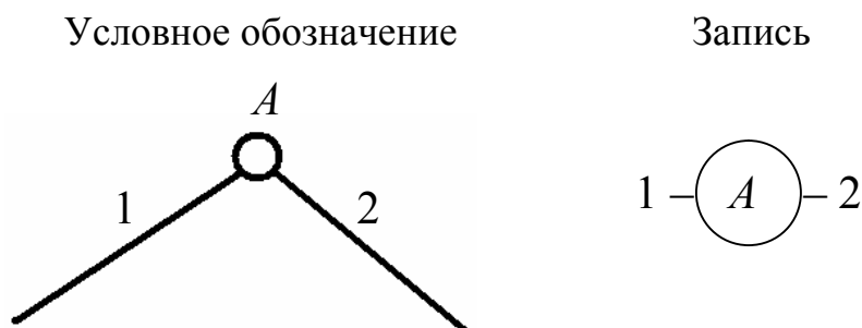
Рис. 1. Вращательная кинематическая пара
